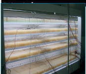
Rys. 4. Regal chłodniczy przeznaczony do dehydracji produktów spożywczych
