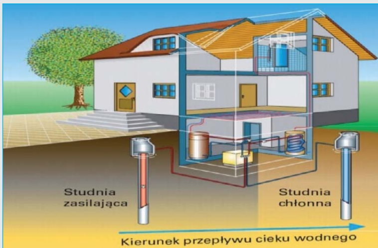
Rys. 3. Schemat pompy ciepła typu woda-woda z sondami pionowymi [6]
