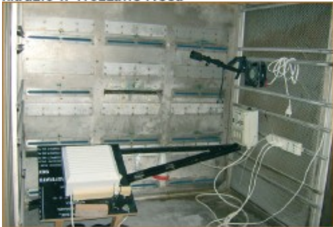
W specjalnej testowej komorze klimatycznej wentylatory są w ciągu pięciu tygodni „postarzane” o 10 lat
